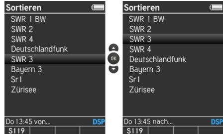
Mit den Tasten „Up“ und „Down“ wird nun der Auswahlbalken mit dem entsprechenden Sender an die gewünschte Stelle gebracht. Mit „OK“ wird der neue Senderplatz bestätigt. Die Statusanzeige wechselt nun wieder zu „von...“
