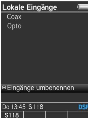
Wählen Sie hierzu auf der Fernbedienung das Feld „Eingänge umbenennen“ aus. Es wird Ihnen eine Liste beider Digitaleingänge angezeigt. Jeden Eingang können Sie nun mit den folgenden Tasten der S208 ändern:
