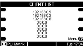
Mit dem Softkey **Menu** kann man zwischen der Menüseite **CLIENT LIST** und den zwei **TCP/IP**-Seiten wechseln.
