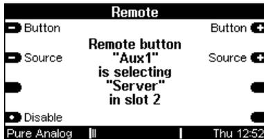
Der Select-Befehl **13:SELECT:AUX1** würde in diesem Fall im Raum 5 der Zone 2 die Quelle **Server** ( des Communication-Moduls in Slot 2 ) aufrufen, und **nicht** die Quelle Aux1.
