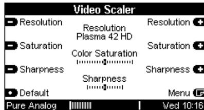
Eine Verschiebung aus der neutralen Mittelstellung in den positiven Bereich erhöht die Schärfenwirkung. Das Bild wirkt detailreicher, bei zu hoher Einstellung bisweilen sogar „pixelig“.
