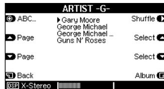
Der Anfangsbuchstabe wird mit dem Drehknopf ausgewählt. Beim Drehen durchläuft man zuerst das Alphabet gefolgt von den Zahlen 0-9. Diese Reihenfolge kann ebenfalls rückwärts durchlaufen werden.
