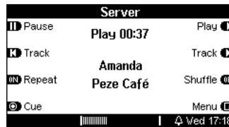
Eine wiederholte Betätigung des Softkeys **Shuffle** aktiviert bzw. deaktiviert die Funktion. Dabei wechselt im Softkey Shuffle die Anzeige zwischen **ON** und **OFF**.
