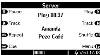
Eine wiederholte Betätigung des Softkeys **Repeat** aktiviert bzw. deaktiviert die Funktion. Dabei wechselt im Softkey Repeat die Anzeige zwischen **ON** und **OFF**.
