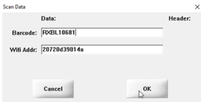
7. Das Tool schreibt nun die Seriennummer ins Image der C200. Wenn alles funktioniert hat, meldet das Tool «Passed» und öffnet ein neues Barcode/Wifi Addr Fenster. Entfernen Sie das USB-C Kabel von der C200 und schließen Sie das SN Tool. Die Slot Abdeckung der C200 kann wieder montiert werden, die Software Anpassungen sind vollständig.
