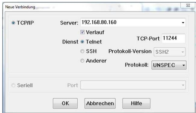
Nach erfolgreicher Verbindung mit dem Server geht man in die Terminal-Einstellungen und setzt "Übertrage" auf AUTO um eine korrekte Zeilenformatierung zu erhalten.
