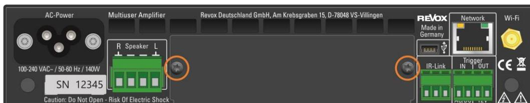
Entnehmen Sie das Modul der Verpackung und führen Sie es in den Steckplatz ein; die beiden Schienen im Innern des M30 Multiuser Amplifier bilden hierbei die mechanische Führung.
