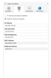
Hier ist die IP-Adresse des Multiuser 3.0 KNX Gateways einzutragen. Diese dient der Adressierung des Gerätes über das IP-Netzwerk (LAN). Die IP-Adressierung sollte mit dem Administrator des Netzwerks abgestimmt werden.
