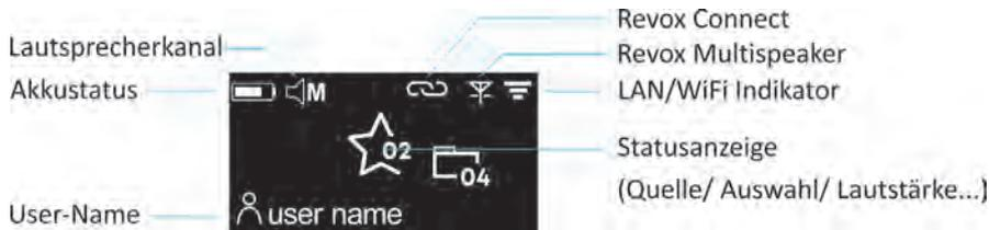
**Revox Connect** ist eine Verbindungsroutine, die mit Hilfe von Bluetooth eine erste Verbindung zwischen dem A200 und Ihrem Mobilfunkgerät herstellt. Über die Multiuser App von Revox kann nun dem Audio-System via Bluetooth-Verbindung das WLAN-Netz mit dessen Schlüssel (Passwort) mitgeteilt werden.
